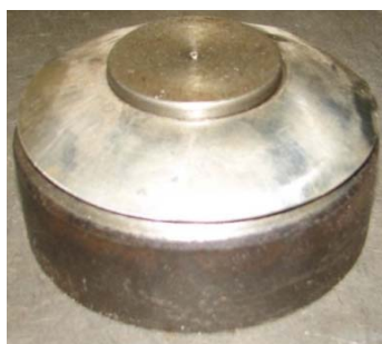
Рис. 6. Образец после приложения давления, позволяющего полностью выгладить гофры
