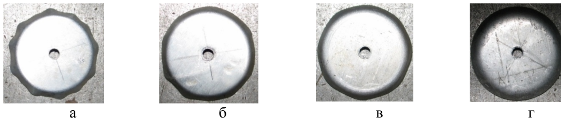
Рис. 5. Образцы с одинаковым углом наклона борта 60^\circ разной толщины: а – 1 мм, б – 1,5 мм, в – 2 мм, г – 3 мм (материал АмГ-АМ)
