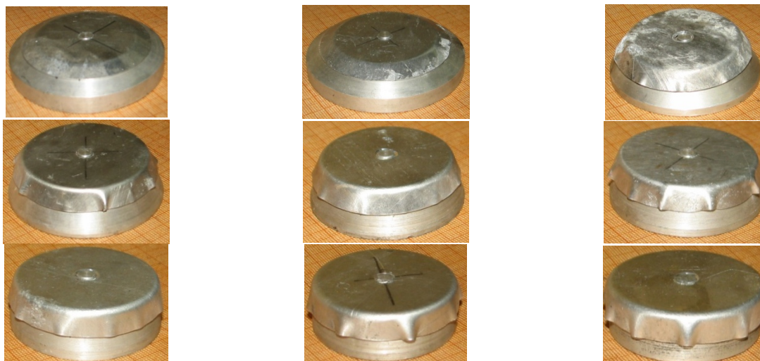
Рис. 3. Отштампованные образцы с переменным углом наклона борта ( S=1 , материал АмГ-АМ)
