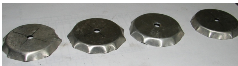
Рис. 4. Образцы с одинаковым углом наклона борта 60^\circ , отштампованные при разном давлении: 10 Мпа, 20 Мпа, 30 Мпа, 40 Мпа ( S = 1 , материал АмГ-АМ)
