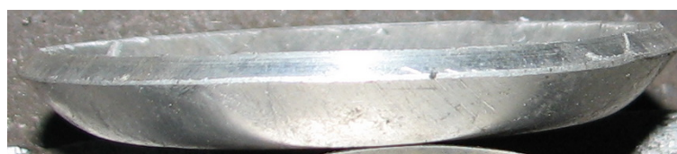
Рис. 7. Деформация толстостенной заготовки
